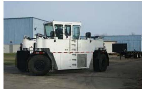
Los cuatro cilindros de elevación equipados con un rodillo en la cabeza proporcionan 30" de recorrido vertical de las zapatas. Cada cilindro elevador esta equipado con un transductor interno de posición que proporciona la sincronización de los cilindros de elevación.
